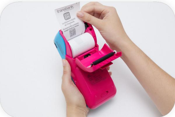
**02** Toma el papel dejando una cola de papel hacia afuera. Inserta el rollo en el equipo, y asegúrate que la cola del rollo de papel sobresalga unos centímetros del equipo.
